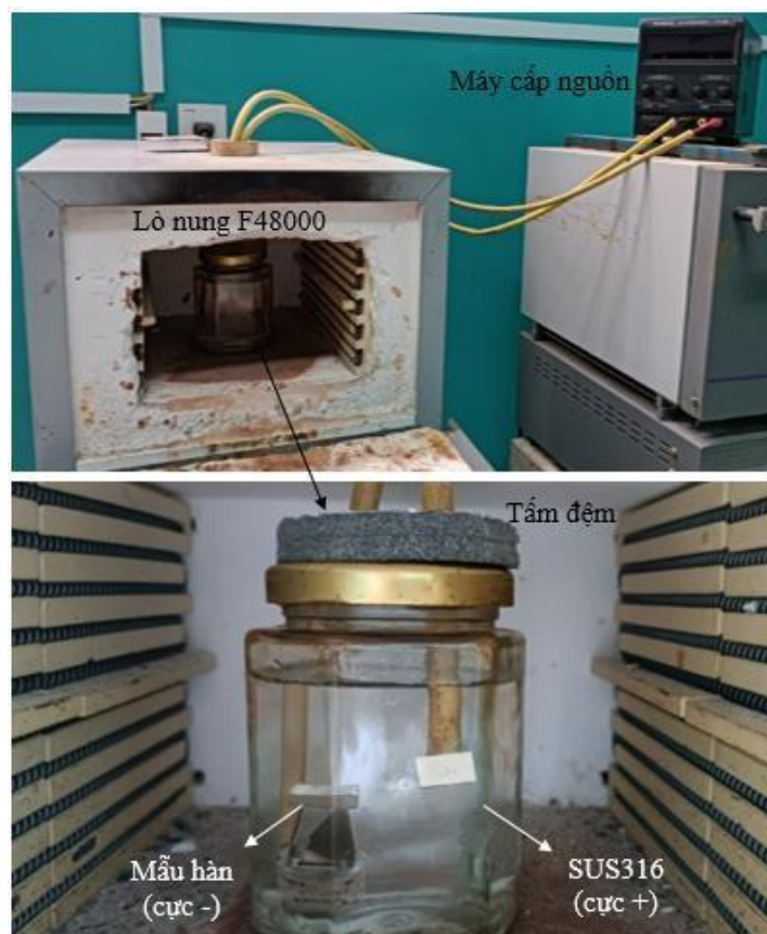
Hình 3.20. Mẫu ngâm 3,0 %NaCl, U = 3V và nhiệt độ khác nhau
