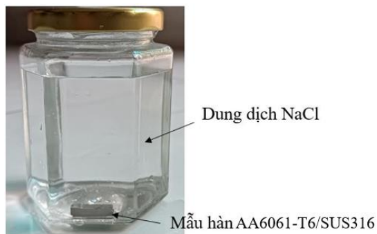
Hình 3.18. Mẫu AA6061-T6/SUS316 ngâm trong dung dịch NaCl
