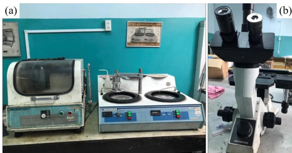
Hình 3.9. (a) Máy cắt mẫu và đánh bóng, (b) kính hiển vi Olympus
