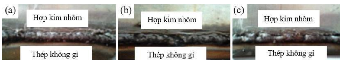
Hình 1.12. Mặt liên kết mối hàn chồng AA6061/SUS304 bằng hàn MIG dưới tác dụng các hiệu điện thế khác nhau (a) 17 V, (b) 18 V, (c) 19 V [117]
