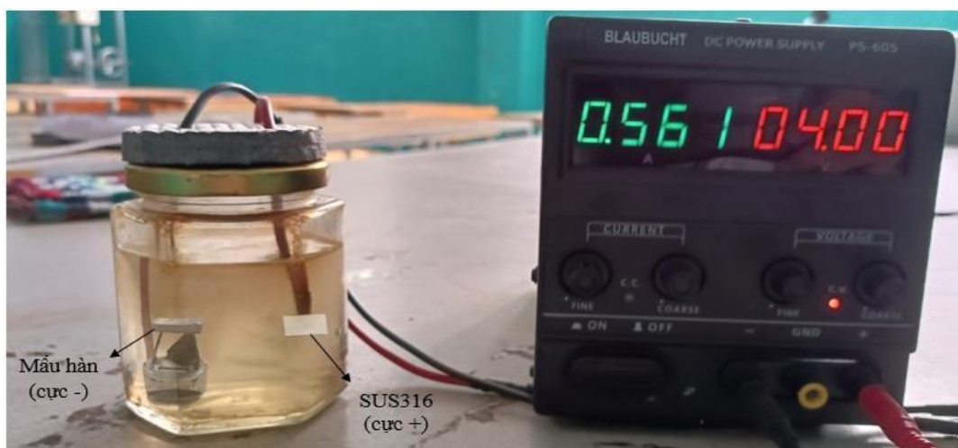
Hình 3.19. Mẫu ngâm dung dịch 3,0 %NaCl và tác dụng hiệu điện thế khác nhau
