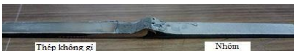
Hình 1.9. Mặt ngoài mối hàn giữa AA6061 với AISI304 bằng phương pháp hàn ma sát áp lực “friction crush welding” [121]
